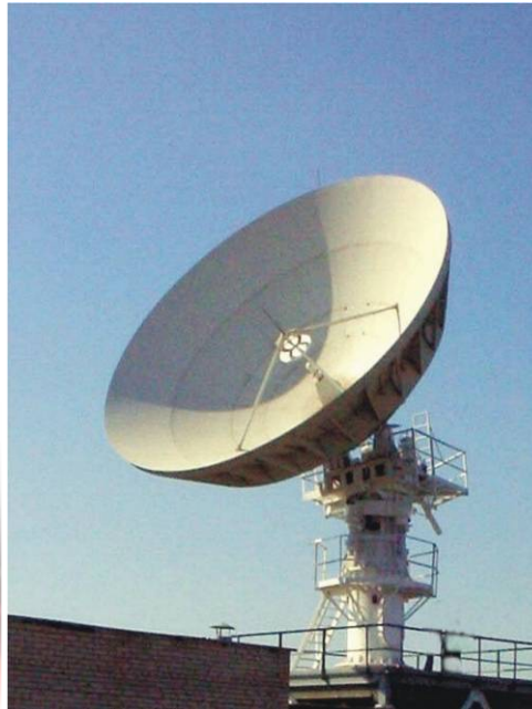
Полноповоротная антенна Диаметром 9 метров для приема данных со спутников дистанционного зондирования Земли.
